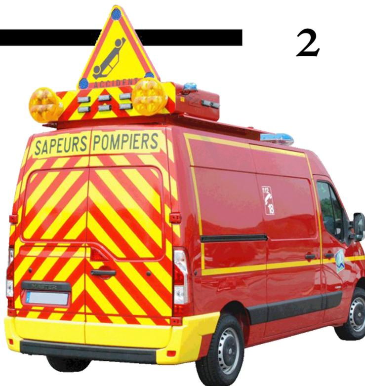
Monsieur Colledani répond que la signalisation se présente sous deux formes, lumineuse (deux feux sur le toit et feu de pénétration et de recul) et adhésive (note de 2011 prévoyant des bandes réfléchissantes sur les faces avant, arrière, et latérale.)
